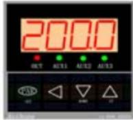
⑧按“PAR”键3秒，退出参数设定状态，返回到测量状态，报警设定结束。
