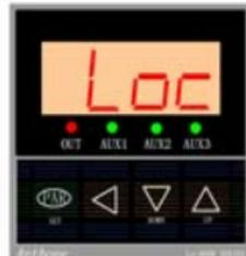
按“PAR”键 3 秒钟放开，进入参数设定状态，显示窗显示第一个参数“Loc”符号，
